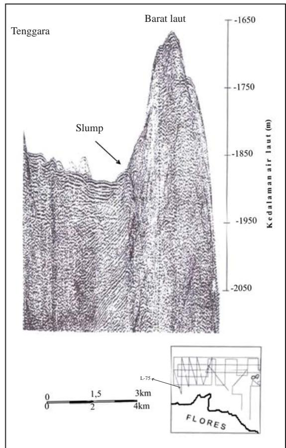
Gambar 9. Rekaman seismik pantul L-75.
