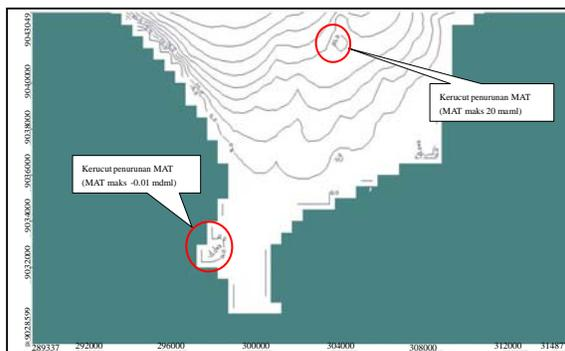
Gambar 29. Kerucut penurunan permukaan air tanah pada *Layer 1* (sistem akuifer batuan vulkanik muda), hasil simulasi kondisi tidak tunak (Qabs-2009=120,1 juta m<sup>3</sup>/tahun).
