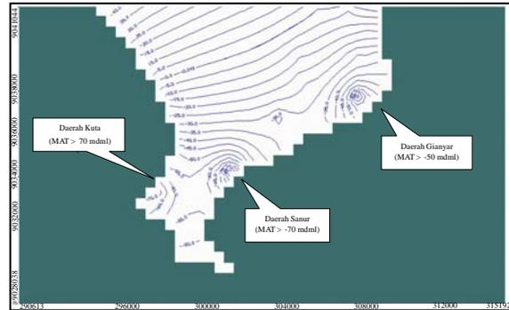
Gambar 30. Kerucut penurunan permukaan air tanah pada *Layer 2* (sistem akuifer Formasi Palasari), hasil simulasi kondisi tidak tunak (Qabs-2009=120,1 juta m<sup>3</sup>/tahun).
