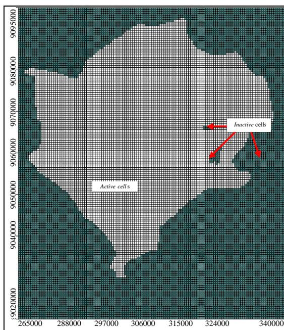
Gambar 4. Rancangan *grid model* beda terbatas CAT Denpasar-Tabanan.
