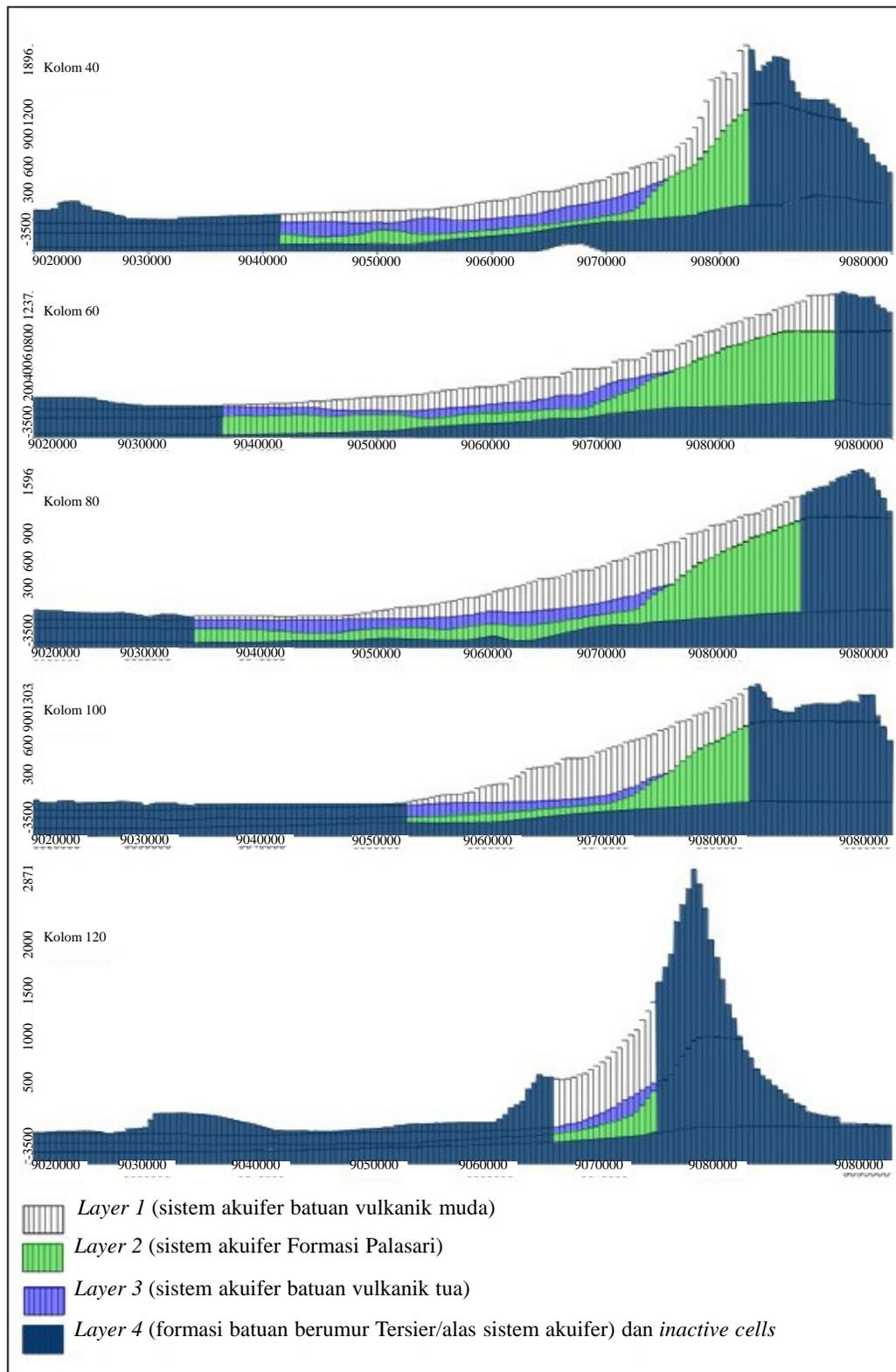
Gambar 10. Penampang hidrogeologi pada kolom 40, 60, 80, 100, dan 120.
