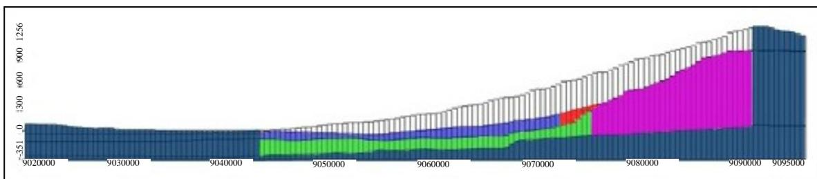
Gambar 12. Zona konduktivitas hidraulik (penampang pada kolom 70).
